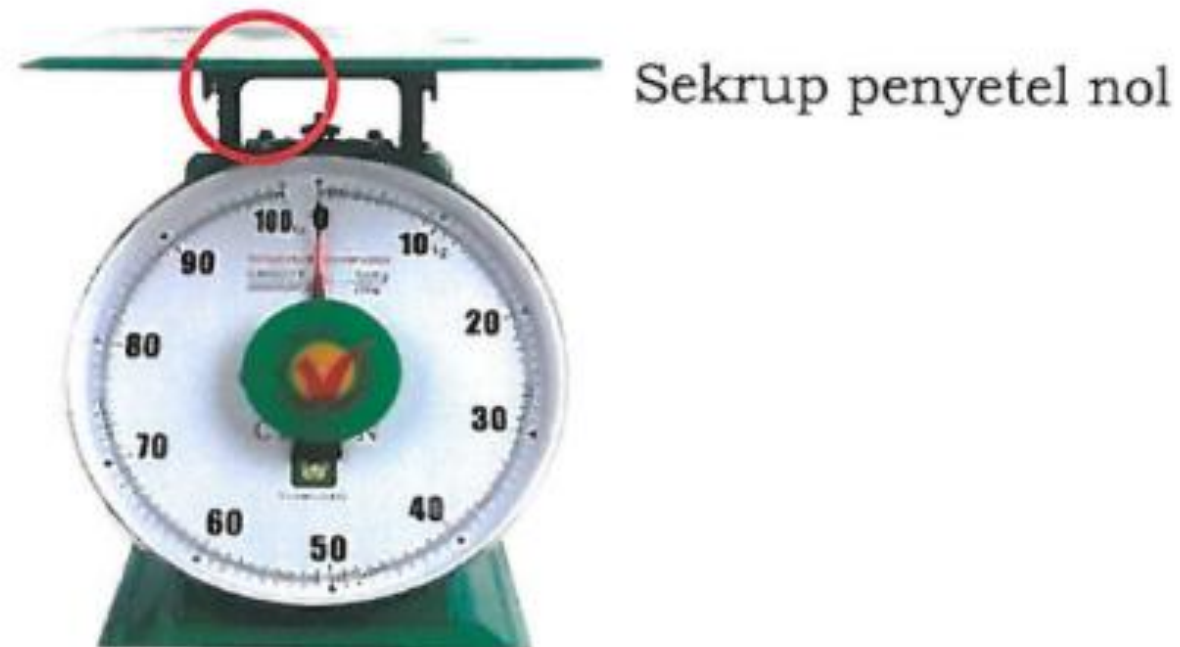
Gambar 5.9. Posisi Sekrup Penyetel Nol Timbangan Pegas
