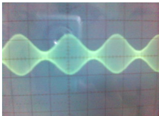
Gambar 1.3 Sinyal keluaran amplitudo modulator
