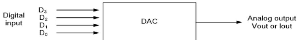
Gambar 1.2 (a) skema symbol dari 4-bit DAC
